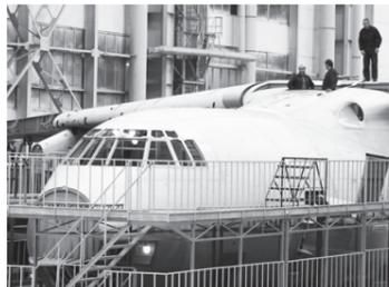
поточные линии для планеров Ил-76МД/ТД-90А, рассчитанные на выпуск 18 самолетов в год и основанные на применении современных технологий бесстапельной сборки.
